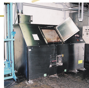
生ごみをコンポスト化する生ごみ高速発酵処理装置
